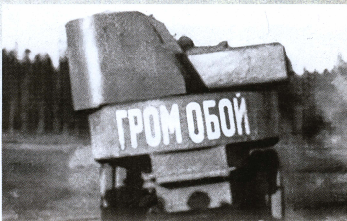
Стрельба из 76-мм пушки броневика «Громобой» вправо по ходу движения: хорошо видно, что при выстреле машину сильно раскачивало. 1915 год.
