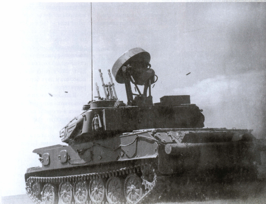
Зенитная самоходно-артиллерийская установка ЗСУ-23-4 ведет огонь. Хорошо видны гильзы, выбрасываемые при стрельбе.
