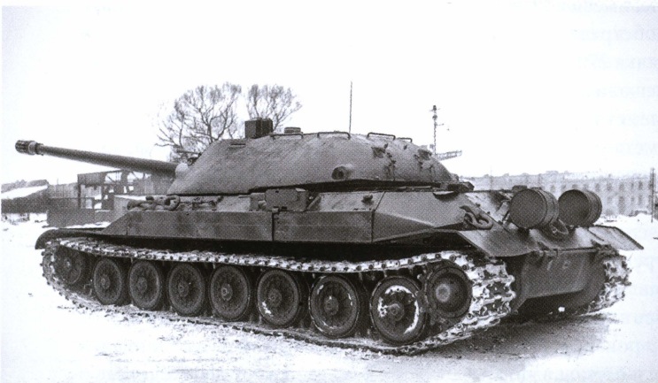
Опытный образец танка ИС-7 (образец № 2) перед началом испытаний, зима 1947 года. На корме корпуса закреплены дымовые шашки.
