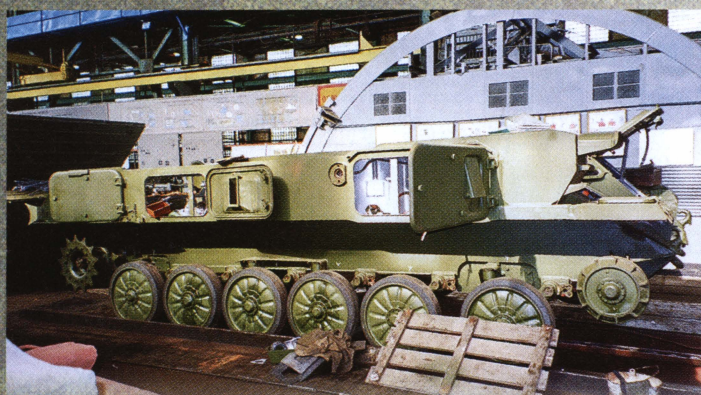
Ремонт базы «Шилки» — гусеничной машины ГМ-575, 2009 год.
