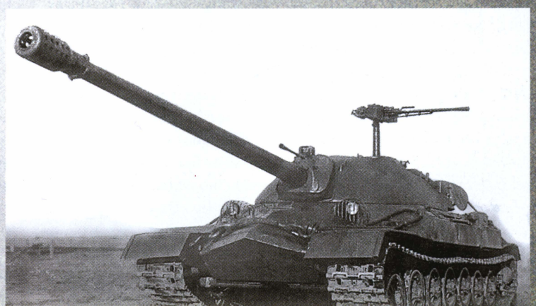
Опытный образец танка ИС-7 (образец № 3), общий вид, осень 1948 года. Хорошо видна зенитная установка 14,5-мм пулемета КПВ.
